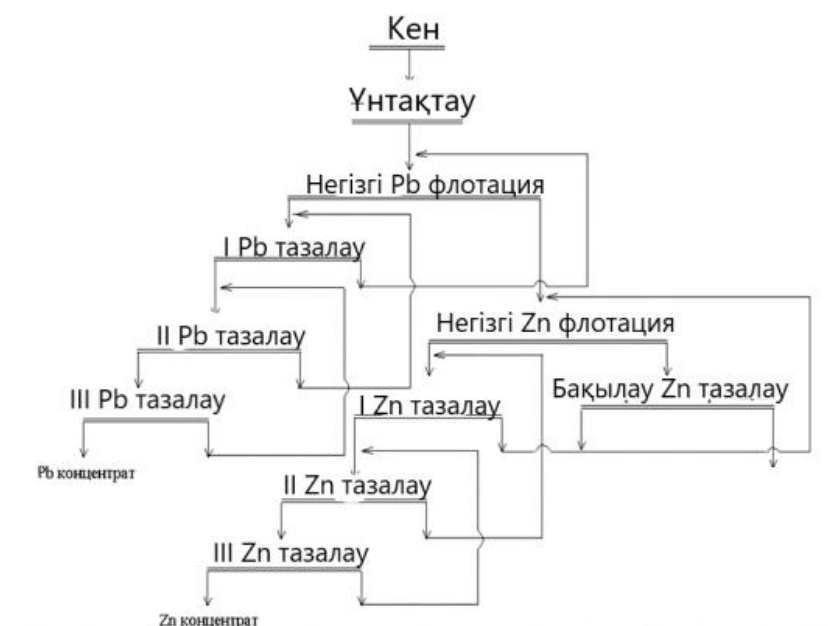
6.1-Сурет. Қорғасын-мырыш кенін қайта өңдеу сызбасы
