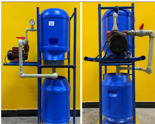
5.7-Сурет. Флотореагенттерді модификациялау (эмульгирлеу) бойынша қондырғы
